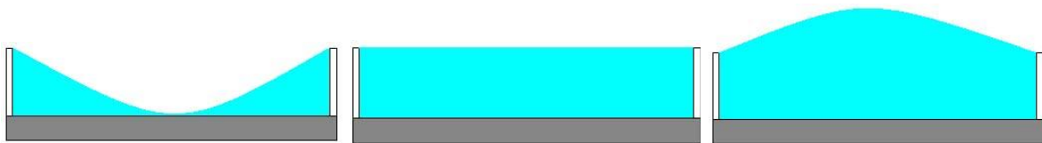
Figure 90- Evolution du remplissage des cuves (sous remplie, bien remplie, sur-remplie)
