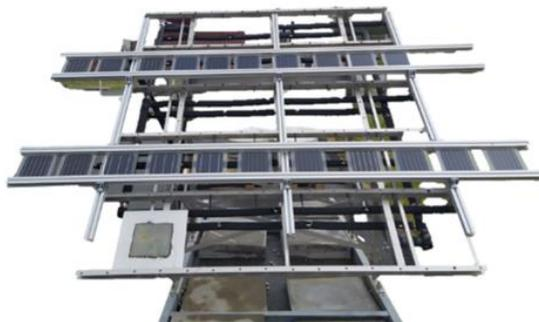
**Figure 53 : Support d'installation des mini-modules photovoltaïques en extérieur.**
