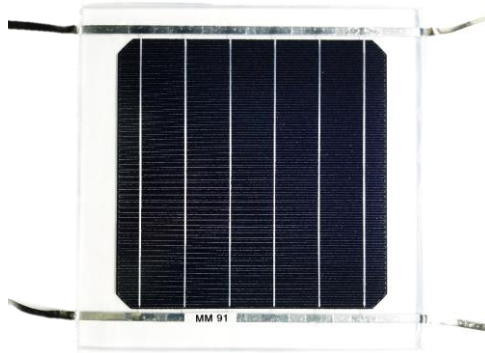
Figure 52 : Photographie d'un mini-module à cellule SHJ non vieilli.
