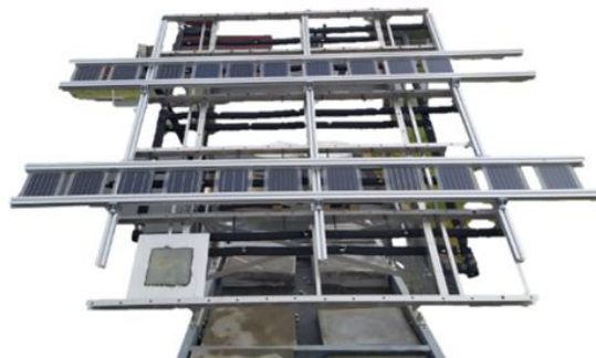
Figure 53 : Support d'installation des mini-modules photovoltaïques en extérieur.
