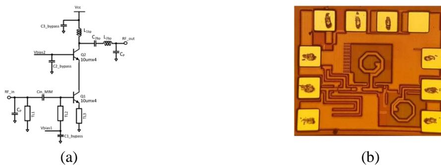
Figure II-10 : (a) Schématic et (b) layout du PA
