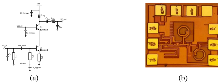
Figure II-10 : (a) Schématique et (b) layout du PA
