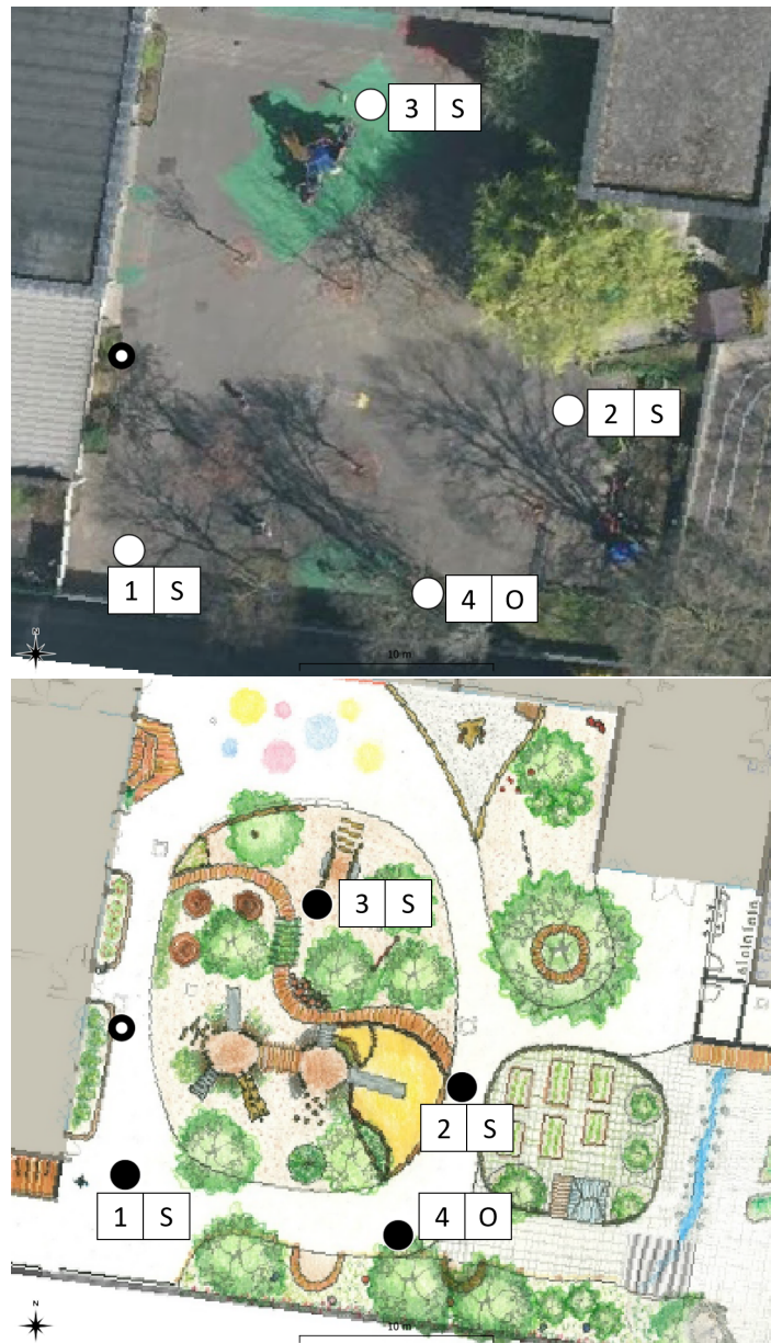
FIG. 5.6 – Haut : points de mesure avant travaux ainsi que leur état d'enseillement (S : au soleil ; O : à l'ombre). Bas : points de mesure après travaux. Le point bicolore (bord noir et centre blanc) représente la position de la station fixe.
