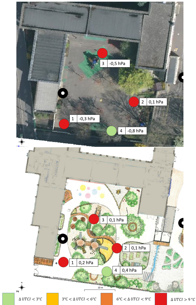
FIG. 5.11 – Écart de la pression partielle de vapeur d'eau à la référence p_{v,i}^{mobile} - p_{v,i}^{ref} mesuré en chaque point au sein de la cour EM M. Hilsz avant (2020) et après (2021) travaux. La couleur des points (cf. légende en bas) indique le niveau de stress thermique relatif.
