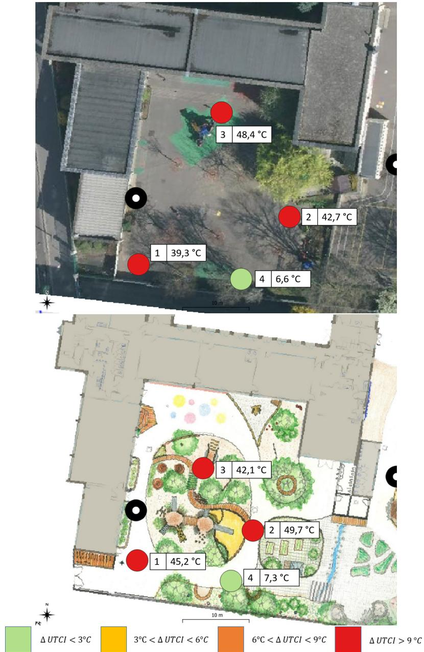
FIG. 5.10 – Surcharge radiante  $T_{mrt,i}^{mobile} - T_{mrt,i}^{ref}$  mesurée en chaque point au sein de la cour EM M. Hilsz avant (2020) et après (2021) travaux. La couleur des points (cf. légende en bas) indique le niveau de stress thermique relatif.
