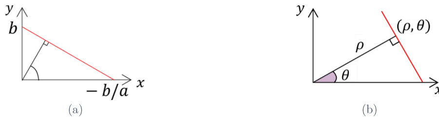
Figure 26 - Caractérisation d'une droite en rouge (a) par ses coordonnées cartésiennes (a, b) et (b) par ses coordonnées polaires (\rho, \theta) .
