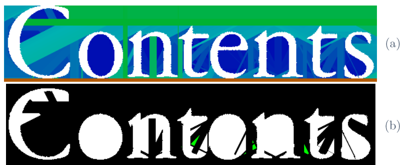
Figure 67 - Illustration du problème des régions vides. (a) RLDT sur le fond de l'image contenant le mot « Contents » (échelle continue du rouge égale à 1 au bleu proche de 0. (b) Binarisation avec un seuil fixé à 0.07 de (a) (avec en vert les composantes connexes vides par rapport à l'image binaire).
