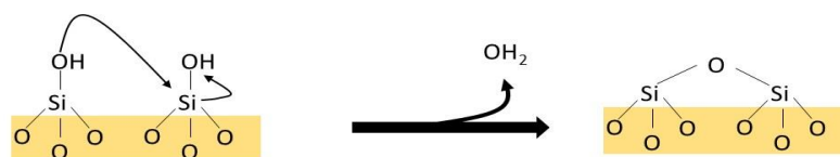
Figure 124. Représentation de la condensation des groupements silanols de surface à haute température.
