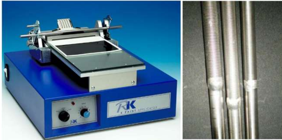
Figure II.26: Enduseur de tiges de laboratoire (à gauche) et les tiges enroulées (à droite).
