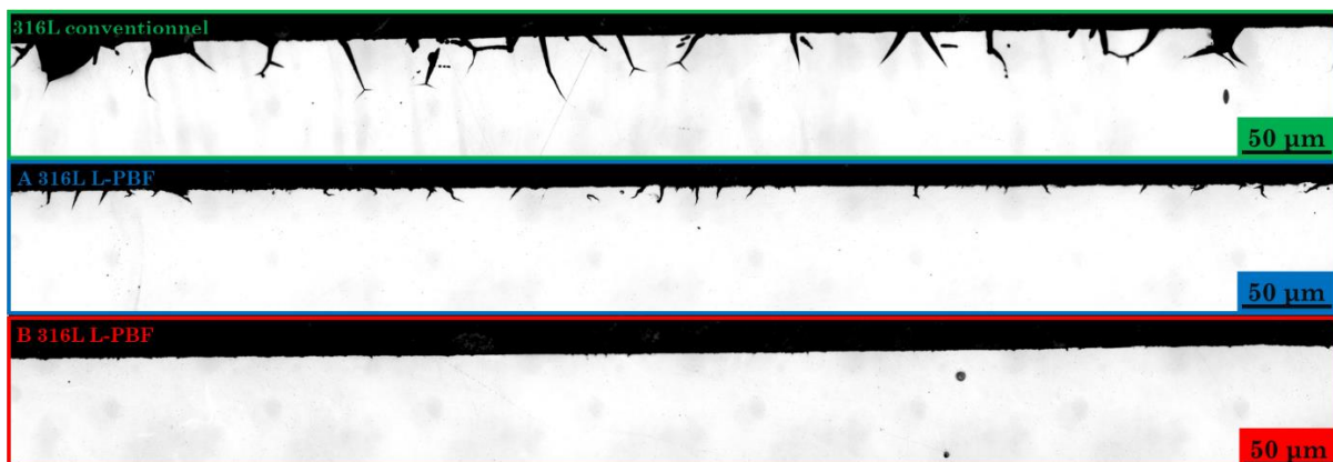
Figure 78 : Observations des aciers 316L en coupes transversales par microscopie optique après 240 h d'immersion dans de l'acide nitrique contenant du V^{5+} à ébullition (107 °C).
