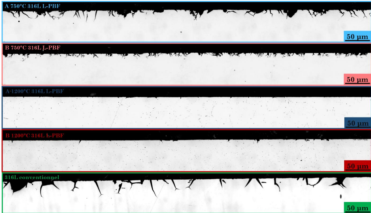
Figure 99 : Observations des aciers 316L traités thermiquement en coupes transverses par microscopie optique après 240 h d'immersion dans de l'acide nitrique contenant du V^{5+} à ébullition (107 °C). Les résultats du 316L conventionnel sont présentés à titre comparatif.
