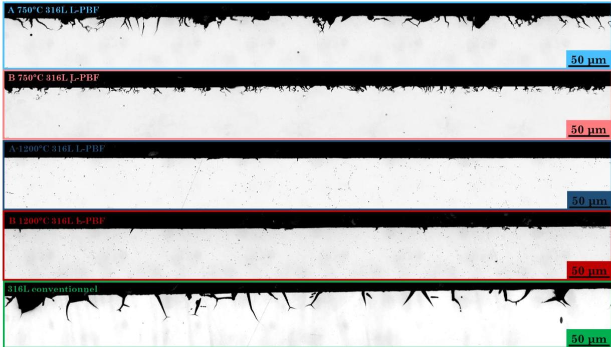
*Figure 99 : Observations des aciers 316L traités thermiquement en coupes transversales par microscopie optique après 240 h d'immersion dans de l'acide nitrique contenant du  $V^{5+}$  à ébullition (107 °C). Les résultats du 316L conventionnel sont présentés à titre comparatif.*
