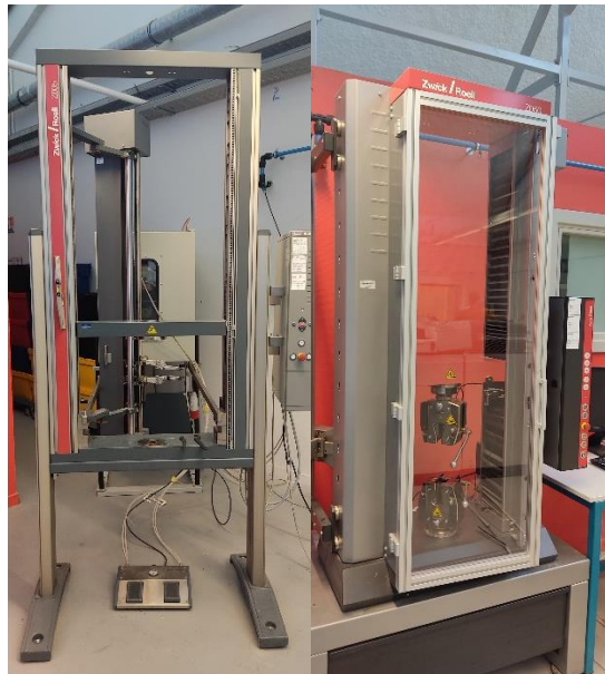
Illustration 10: Machines d'essais mécaniques (traction, compression, flexion) à l'INSA de Strasbourg, à gauche, Zwick Roell® Z005 (maximum 5 kN), à droite, Zwick Roell® Z050 (maximum 50 kN)
