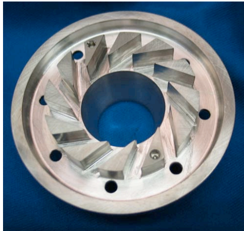
FIG. 6.2 - Photographie de la pièce constituant l'injecteur. On y voit les fentes empruntées par l'écoulement d'air pour introduire le swirl (design Turboméca).
