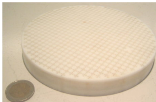
FIGURE 3.4: Photo du support de filtration en Téflon ®
