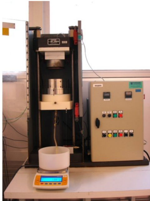
FIGURE 4.4: Cellule de filtration-compression dans la presse
