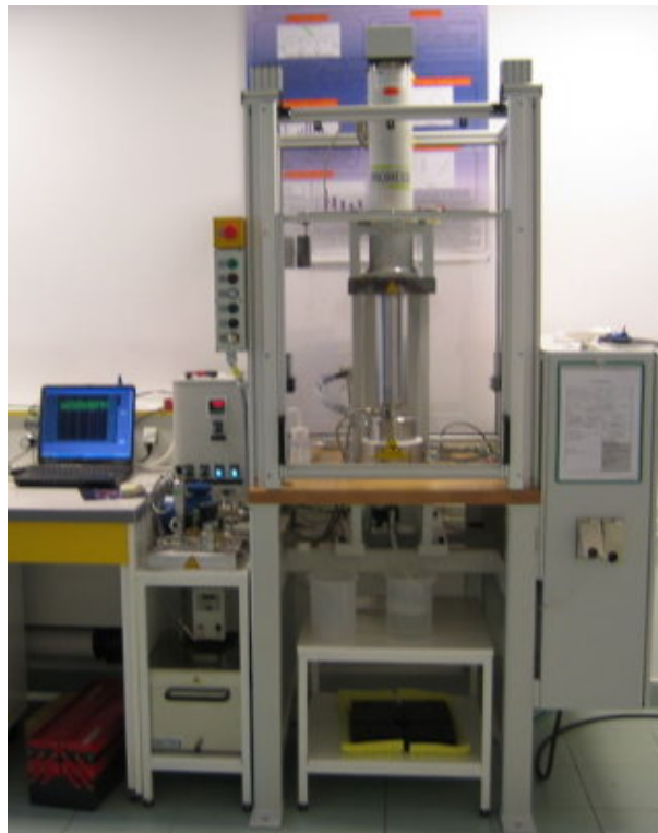
FIGURE 3.7: Installation de la cellule de compression perméabilité
