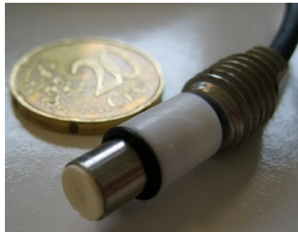
FIGURE 4.11: Photo d'un capteur de pression liquide avec son dispositif de fixation.
