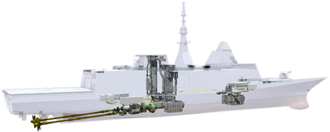
FIGURE 1.2 – Vue des lignes d'arbres et de l'appareil propulsif équipant une FREMM, source : NAVAL Group
