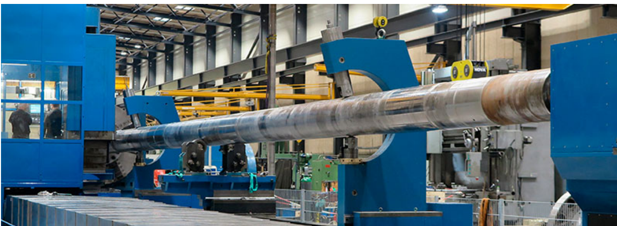
FIGURE 1.4 – Exemple de l'importante longueur d'un arbre usiné sur tour par l'entreprise Marine-Shaft, source : MarineShaft
