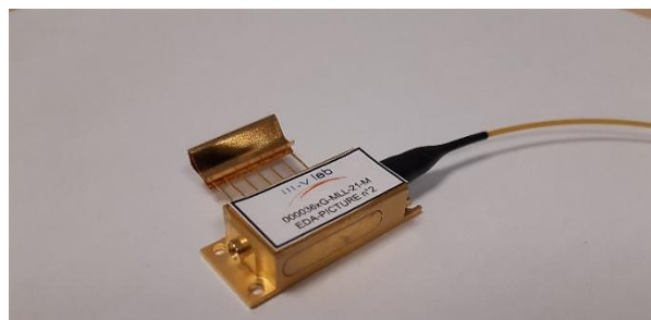
Figure 19 Module Butterfly de notre laser à verrouillage de modes (intégration réalisée au III-VLab).
