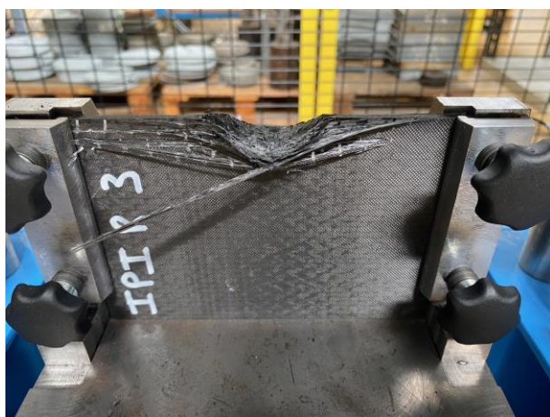
Figure A.20 – Epreuve impactée dans le plan à 330J
