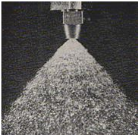
(a) Photographie du liquide à la sortie de l'atomiseur. Source : http://www.delavaninc.com
