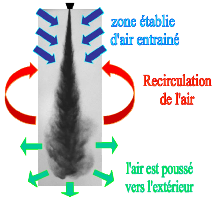
Figure 1.4 : Image ombroscopique d'un spray Diesel et schéma explicatif de l'évolution de l'écoulement gazeux autour du spray
