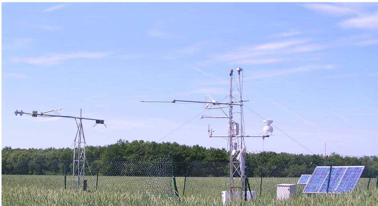
Figure 3.1 : Station d'EC installée sur le site de Lamasquère (31).
