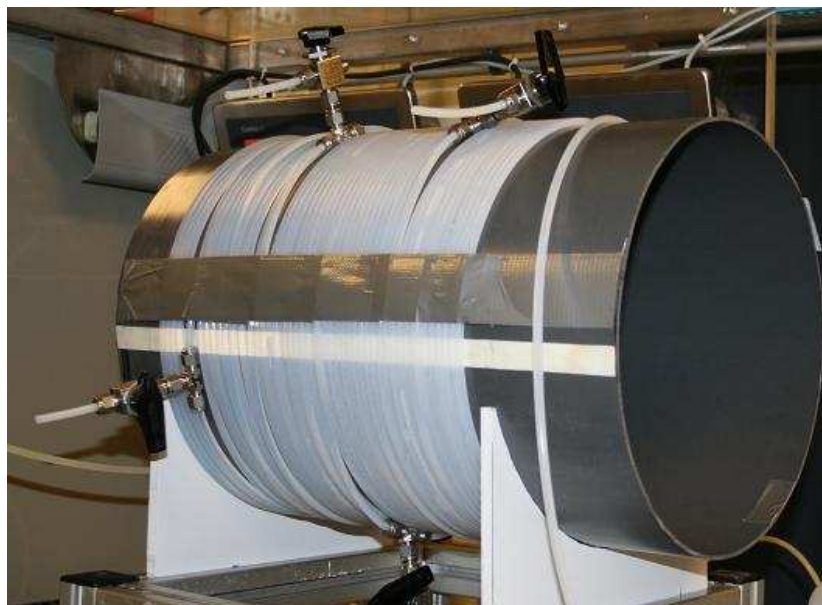
Figure I0-9 : Réacteur tubulaire enroulé employé pour la mise en œuvre de l'encapsulation en continu
