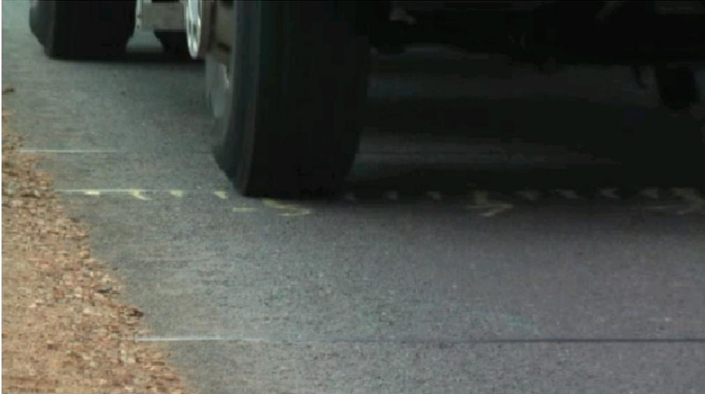
FIGURE 10.15 – Passage 1 - Image extraite de la vidéo montrant le pneu avant droit sur le capteur à fibres optiques.
