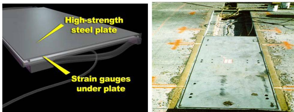
FIGURE 4.6 – Présentation d’un capteur « bending plate », source ORNL.
