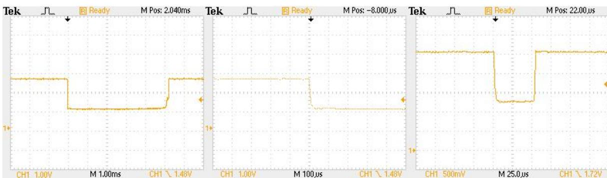
FIGURE 11.8 – Temps de réponse mécanique du capteur résistif conditionné dans de la résine mesuré à l'aide d'un oscilloscope numérique avec à gauche une sollicitation réalisée par une massette, au centre un zoom sur la transition descendante et à droite une sollicitation réalisée avec un maillet.
