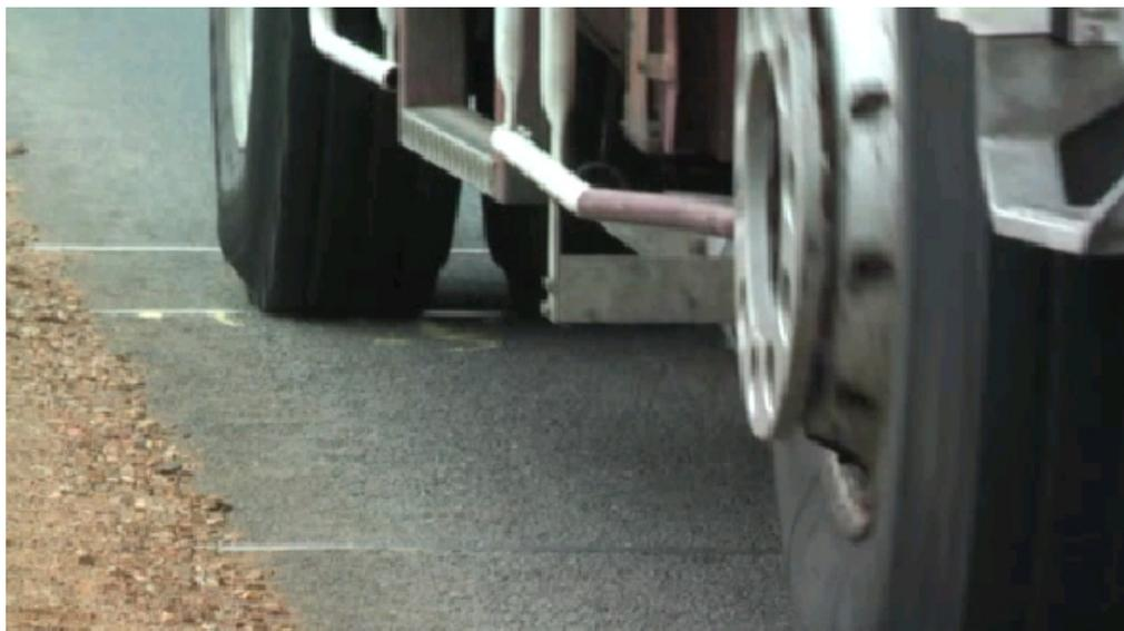
FIGURE 10.20 – Passage 1 - Image extraite de la vidéo représentant l'essieu arrière sur le capteur à fibres optiques.
