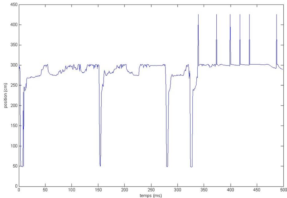
FIGURE 11.10 – Signature d'un camion sur le capteur n°22.
