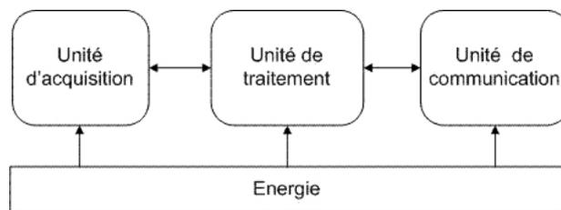
FIGURE 2 – Les différentes unités d'un capteur intelligent.
