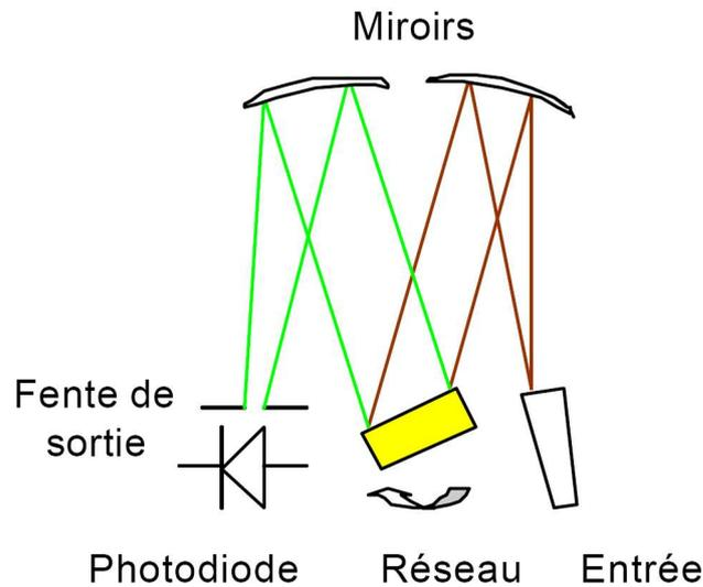
FIGURE B.8 – Analyseur de spectre optique à réseau de diffraction.
