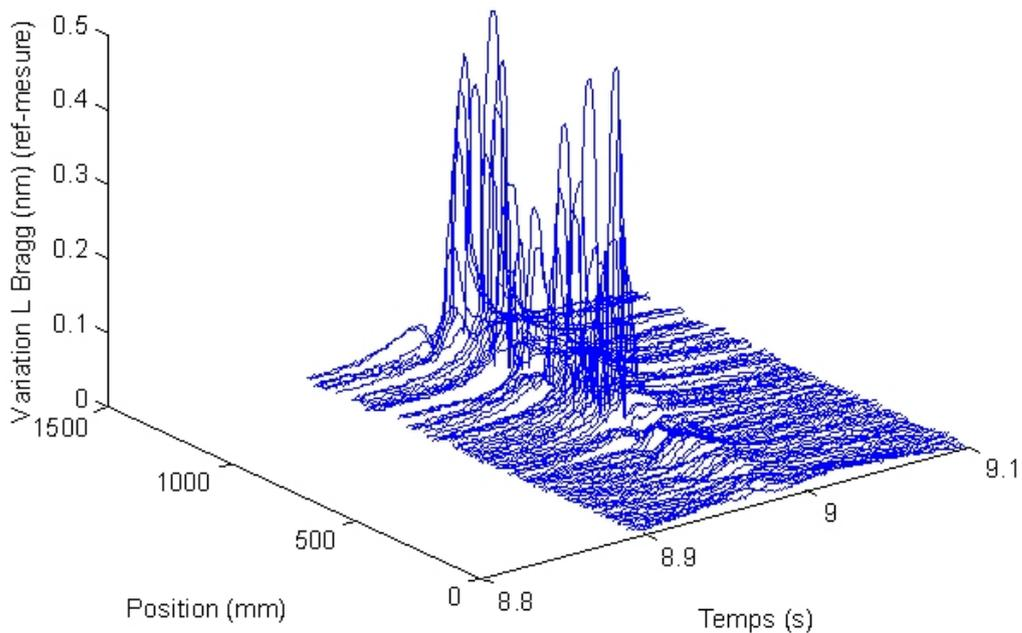
FIGURE D.24 – Passage 5 - Valeur absolue de la variation des longueurs d'onde centrales des différents réseaux de Bragg abs(référence - mesure) sur CFO 1 en fonction de la position physique des réseaux et du temps.
