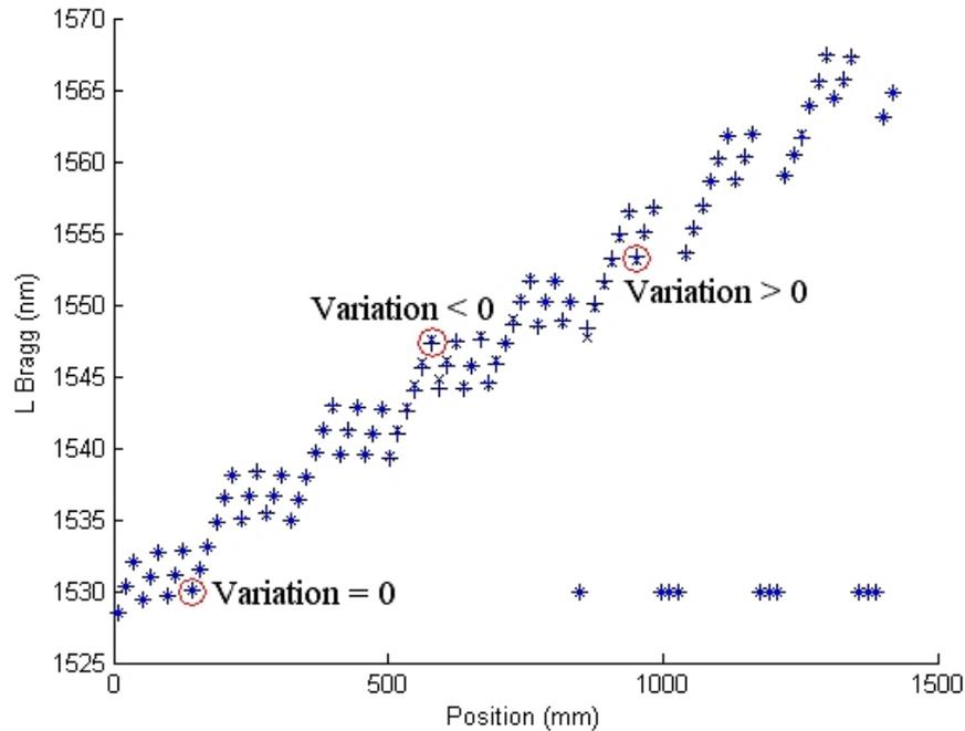
FIGURE 10.1 – Relevé des longueurs d'onde de Bragg centrales sur CFO 1 pour la référence sans véhicule (+) et lorsque la contrainte exercée par l'essieu avant du véhicule appui sur le capteur sans déplacement (x) en fonction de la position sur ce capteur.
