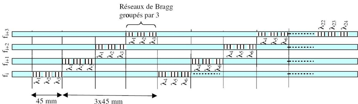
FIGURE 7.8 – Présentation du système réel optiques à réseaux de Bragg.
