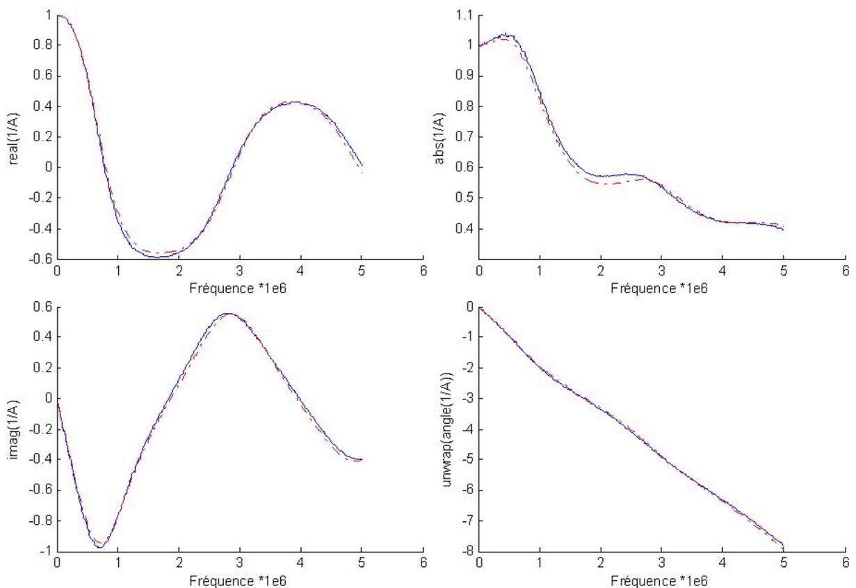
FIGURE 8.10 – Représentation de la partie réelle (en haut à gauche), imaginaire (en bas à gauche), absolue (en haut à droite) et angulaire (en bas à droite) du paramètre  $(1/A)$  sur le capteur de 3 m de long. La partie mesurée est en bleu, trait plein, et la partie obtenue par le modèle est en rouge, trait discontinu.
