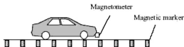
FIGURE 4.22 – Système de localisation à base de magnets.
