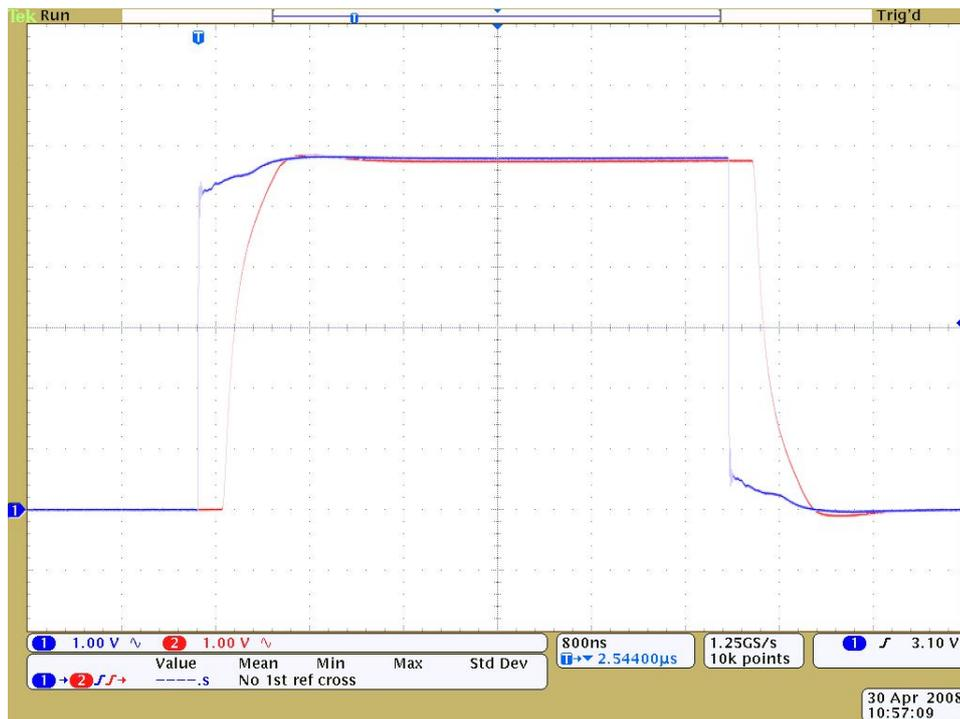
FIGURE 8.12 – Réponse impulsionnelle du capteur de 3 m.
