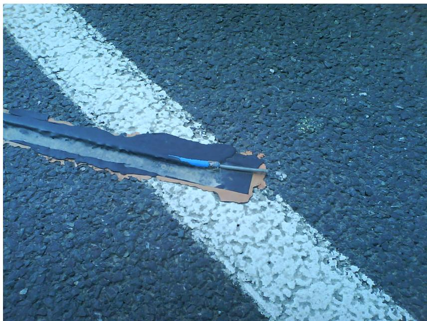
FIGURE E.9 – Allongement du capteur suite à de nombreux passages.
