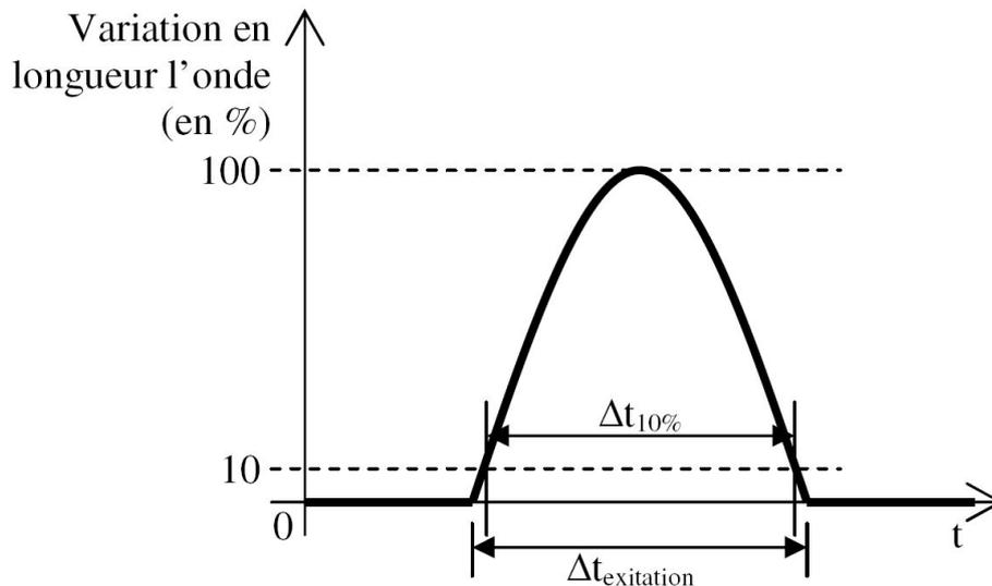
FIGURE 7.13 – Représentation des temps mesurés suite à l'excitation d'un objet en mouvement sur le capteur.
