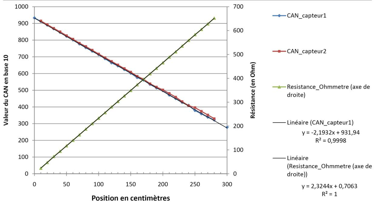
FIGURE 8.4 – Étude des mesures en sortie du CAN de deux capteurs par des appareils différents (carte électronique, échelle de gauche et ohmmètre, échelle de droite) en fonction de la position du point d'impact sur le capteur.
