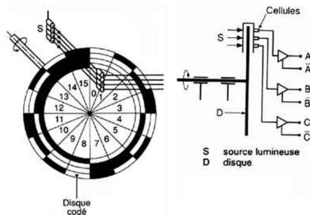
FIGURE 4.19 – Codeur absolu ou de position à 16 segments.
