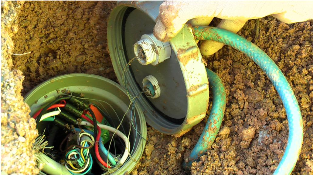
FIGURE E.8 – Photographie d'une remontée du tube en PVC contenant un noeud (carte électronique), les câbles électriques et deux arrivées de capteur (deux tuyaux traversant le couvercle, en bleu).
