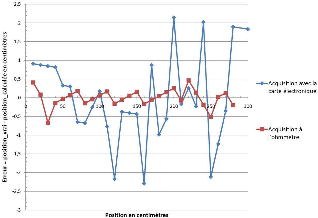
FIGURE 8.5 – Erreur de mesure de la position liée à l'utilisation de la droite de régression linéaire pour la mesure effectuée avec la carte électronique (en losange bleu) et pour la mesure effectuée à l'ohmmètre (en carré rouge).
