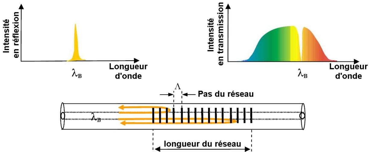
FIGURE 7.2 – Principe de fonctionnement d'un réseau de Bragg.
