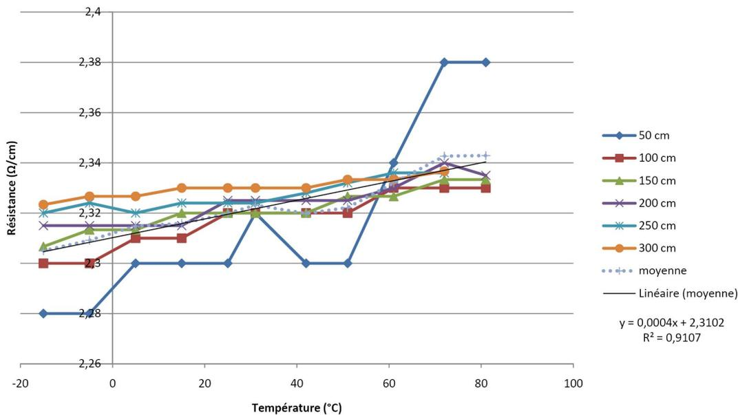
FIGURE 8.17 – Evolution de la résistance linéique en fonction de la température pour différentes positions.
