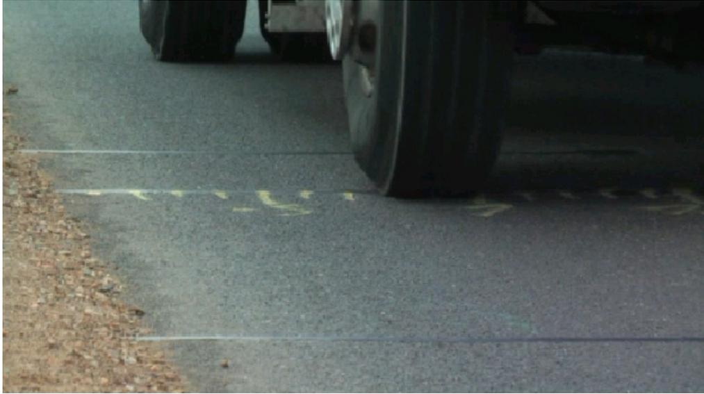
FIGURE D.21 – Passage 5 - Image extraite de la vidéo montrant le pneu avant droit sur le capteur à fibres optiques.
