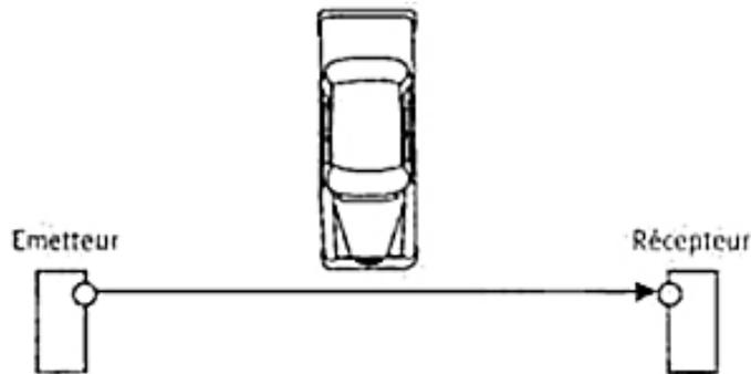
FIGURE 4.9 – Configuration des capteurs suivant le mode barrage.
