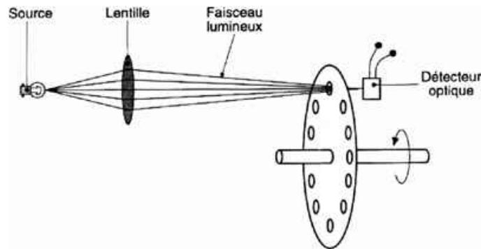
FIGURE 4.20 – Tachymètre optique.
