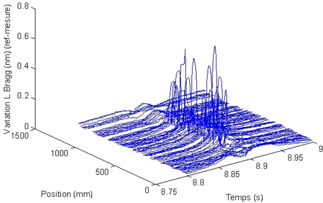
FIGURE 10.18 – Passage 1 - Valeur absolue de la variation des longueurs d’onde centrales des différents réseaux de Bragg ( $|\text{référence} - \text{mesure}|$ ) sur CFO 1 en fonction de la position physique des réseaux et du temps.
