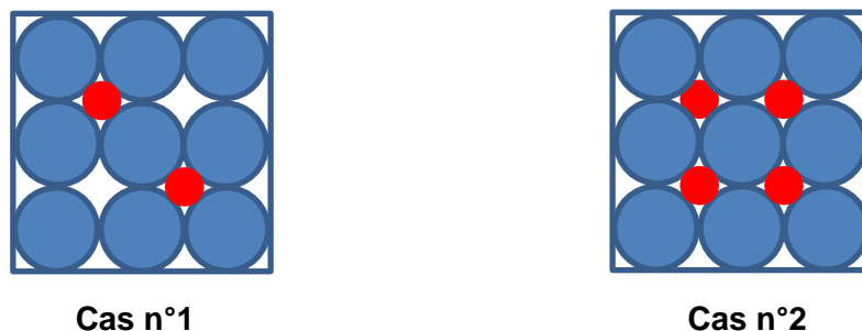
Figure 25 : Empilement incohérent des particules « Cas n° 1 » ; empilement compact des particules « Cas n° 2 »
