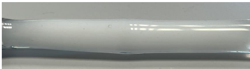
Figure 31 : Préforme de silice dopée partiellement vitrifiée.
