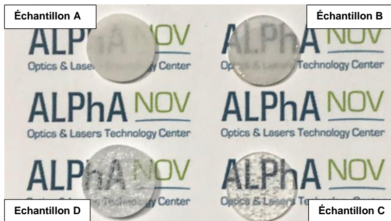
Figure 40 : Échantillons obtenus après frittage par flux visqueux
