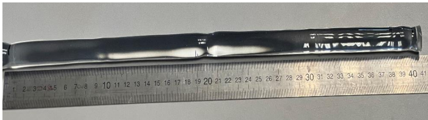
Figure 33 : Préforme YAP vitrifiée suite au traitement des cylindres sous gaz de C_2F_6 .
