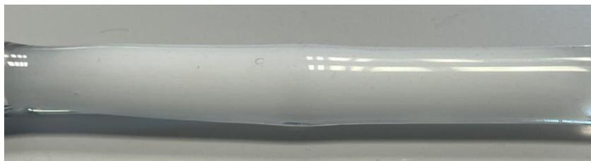
Figure 31 : Préforme de silice dopée partiellement vitrifiée.
