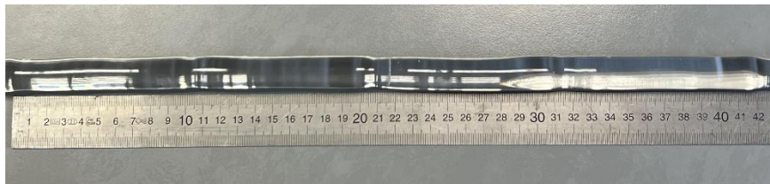
Figure 35 : Préforme du système PAS vitrifiée
