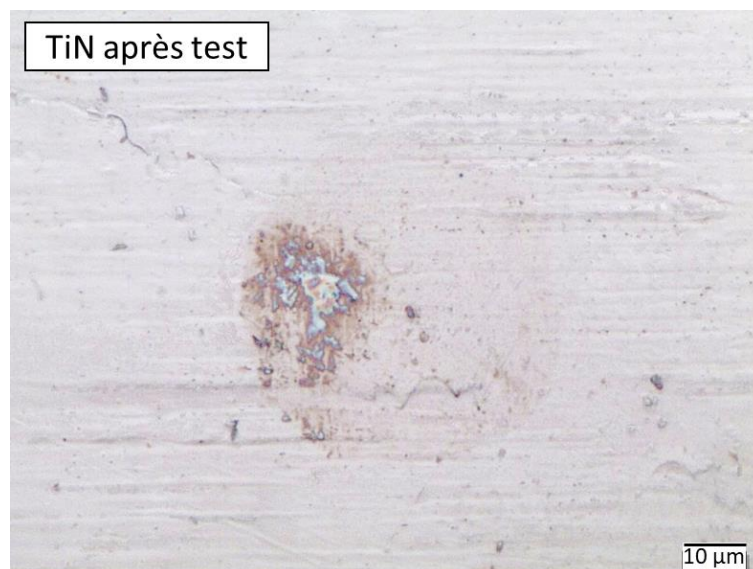
Figure 1.24 : Zone d'oxydation à la surface d'un TiN après le test
