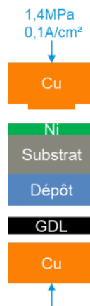
Figure 2.19 : Schéma de l'empilement permettant de mesurer la RCI
