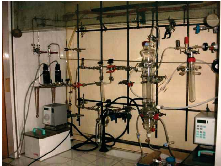
Figure 7: Procédé FB-CVD pour l'élaboration de catalyseurs
