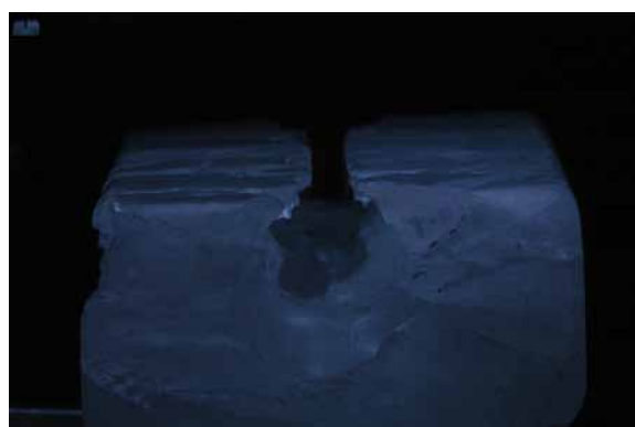
FIG. 10.27 – Essai de dissolution sur une pierre d'Alun de 65 * 42 * 20 mm avec de l'eau à pH neutre et à débit constant. (a) vue de dessus de la pierre d'Alun après dissolution, (b) vue de la face amont et (c) vue de la face aval. Photos prises par Fabien Chauvet et Ian Billanou.
