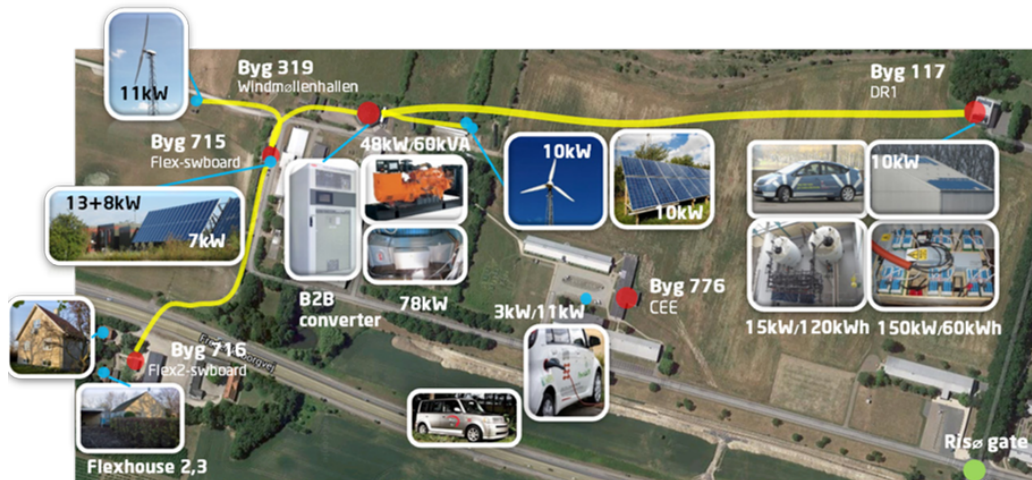
FIGURE 1.11 – Visualisation des composants principaux du laboratoire SYSLAB au DTU. (Source : DTU [17])
