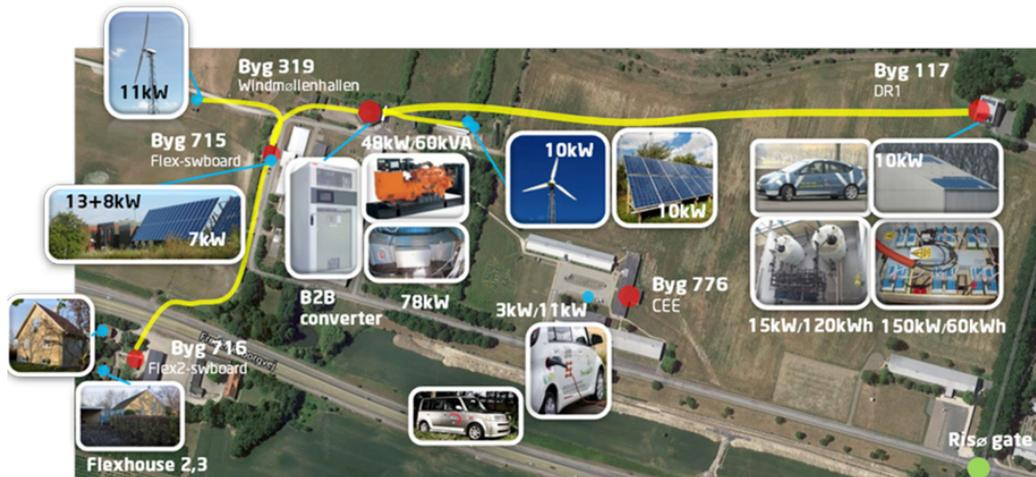
FIGURE 1.11 – Visualisation des composants principaux du laboratoire SYSLAB au DTU. (Source : DTU [17])
