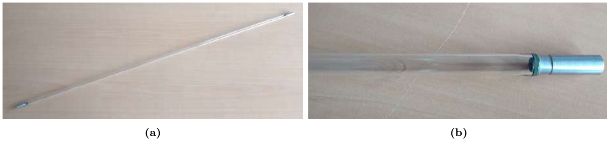
FIGURE 6.21 – Photographies du tube en verre. (a) Tube dans son ensemble (b) Transition verre-métal, la soudure est visible par une ombre sur la gauche de la photographie.
