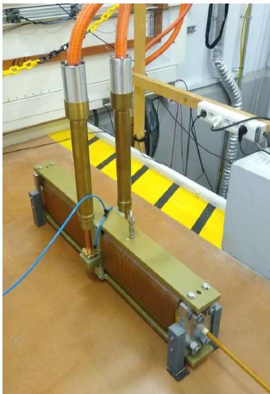
FIGURE 6.20 – Photographie de la nouvelle bobine Foil Coil pendant la phase de test. Les deux amenées de courant de part et d'autre de l'aimant sont visibles. Le tube bleu amène l'air à l'intérieur de la bobine.
