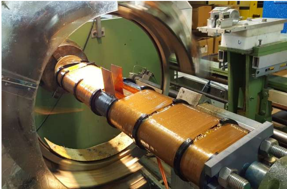
FIGURE 2.18 – Application du renfort mécanique sur la Foil Coil. Les fibres de Zylon, de couleur orangée, sont enroulées autour de la bobine grâce à des demi cylindres, en noir, tenus par des tirants M20.
