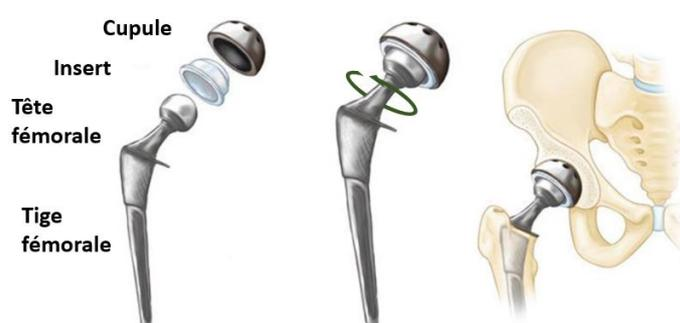
Figure 23 : **Illustration d'une prothèse totale de hanche** (source<sup>191</sup>). Parmi les composants, on peut identifier de haut en bas : la cupule qui se fixe dans l'os iliaque, avec ici un insert en bleu clair qui vient recouvrir l'intérieur de la cupule ; la tête fémorale qui coiffe l'extrémité de la tige fémorale. La tige fémorale est solidement stabilisée dans le fémur. La fonction articulaire se fait à l'interface de la tête fémorale et de la cupule, ou comme ici de l'insert.
