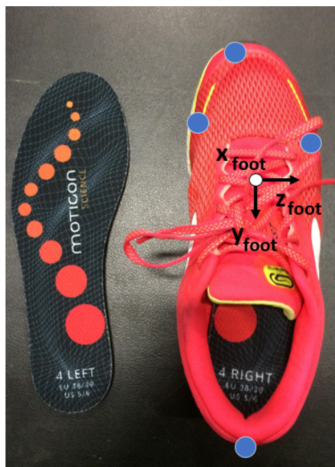
FIGURE 2.5 – Chaussure équipée d'une semelle de pression et de marqueurs dont l'étude de la position permet la synchronisation des données et permettant la construction du référentiel du pied.
