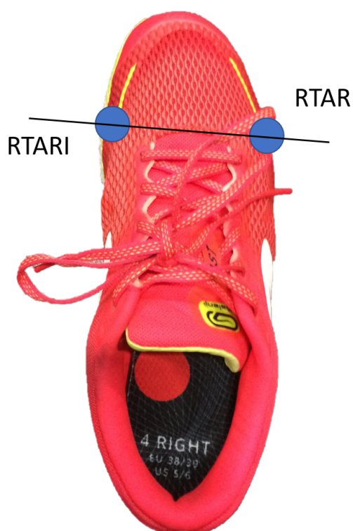
FIGURE 4.2 – Photo d'une chaussure sur laquelle est représentée la position des marqueurs « RTARI » et « RTAR ». L'axe entre les deux marqueurs correspond à l'axe de la liaison pivot considérée entre les métatarses et les phalanges du pied dans le modèle de pied en deux segments.
