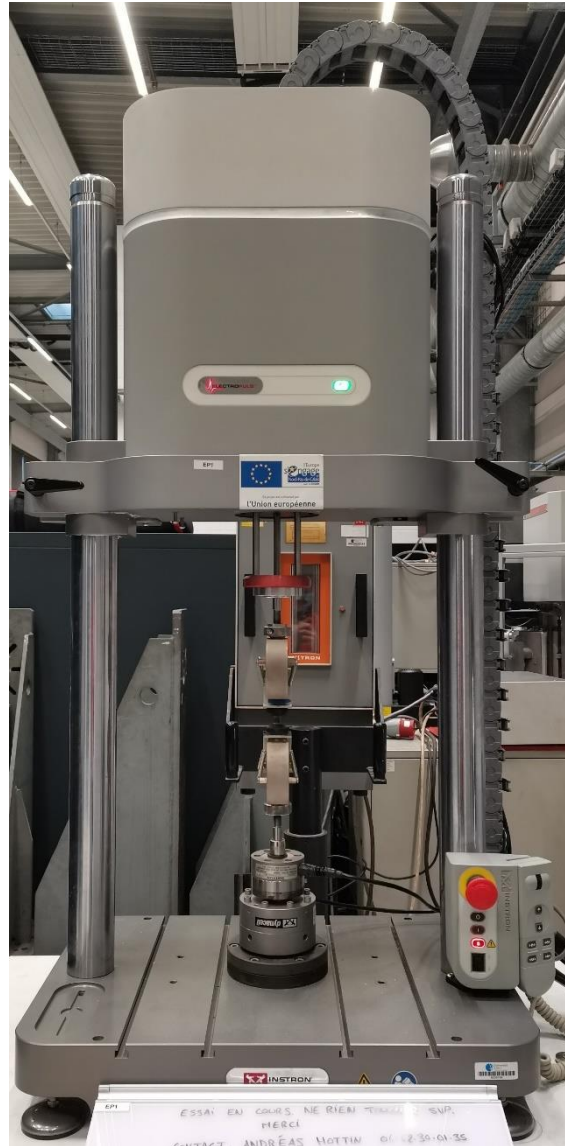
Fig.VI.3 : Dispositif d'essais de fatigue uniaxiaux Instron Electropuls 3000®
