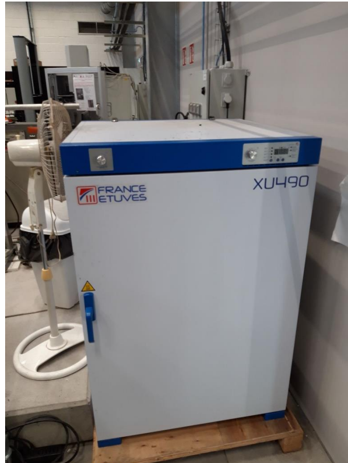
Fig.VI.6 : Étuve FranceEtuve XU490® utilisée pour le vieillissement accéléré.
