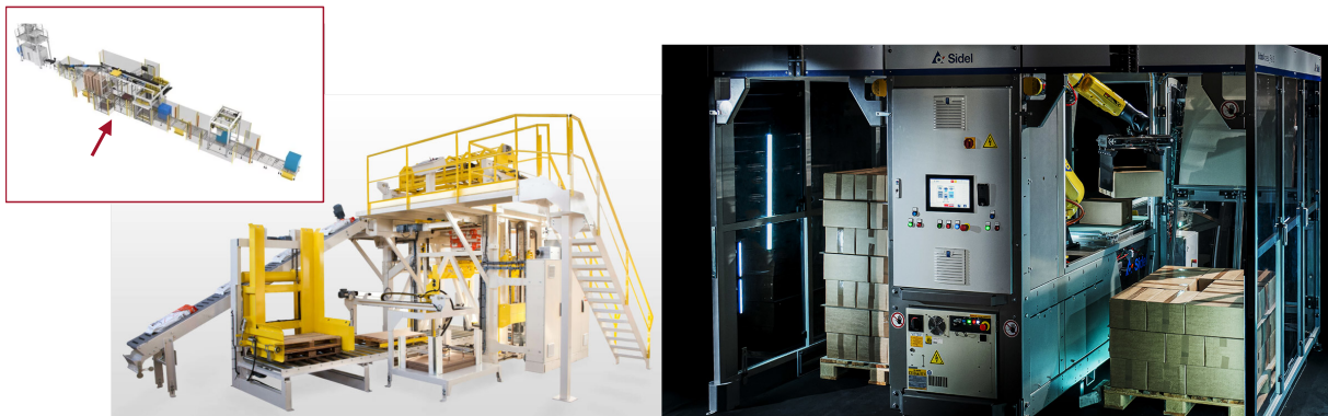
FIGURE 2.1 – Exemples de cellules de production. Gauche : palettiseur à couches CETEC, détail : intégration dans une ligne de production. Droite : palettiseur SIDEL intégrant un bras de robot sériel. (©CETEC, ©NEWTEC BAG, ©Sidel).
