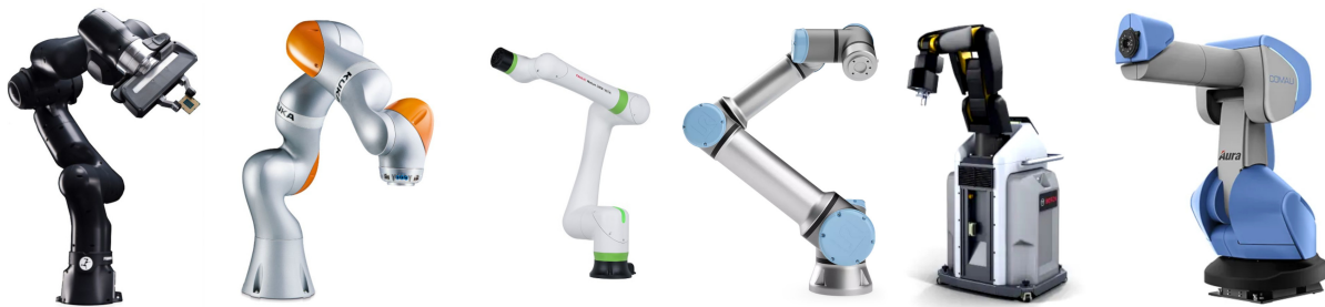
FIGURE 1.2 – Principaux cobots commercialisés : Franka Production 3 ©Franka Emika, LBR iiwa ©Kuka, CRX-10 ©Fanuc, UR16 ©Universal Robot, APAS ©Bosch, AURA ©Comau.
