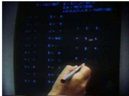
Fig. 23 : Changement des valeurs de variables sur l'écran tactile grâce à un stylet
