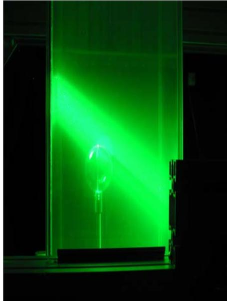
FIG. 3.9 – Visualisation du passage de la nappe laser à travers les sphères en polystyrène transparent.
