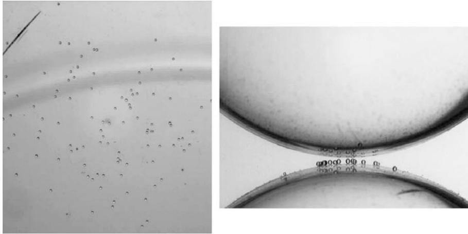
FIG. 3.20 – Expérience de suivi de particules déposées à la surface de la sphère fixe. Vue de dessous (à gauche) et vue latérale (à droite).
