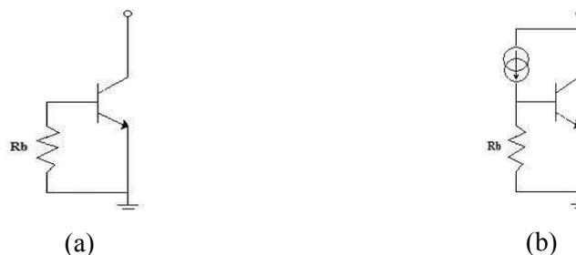
**Figure 1-12 : Représentation schématique du transistor bipolaire NPN utilisé comme protection ESD dans les deux types de configuration : (a) autopolarisé ou (b) polarisé par une source de courant externe  $I_{ext}$ .**
