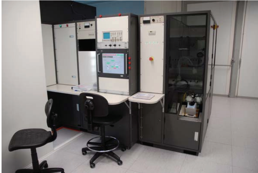
Figure III-7 : l'implanteur ionique Axcelis Eaton NOVA 4206 du LAAS
