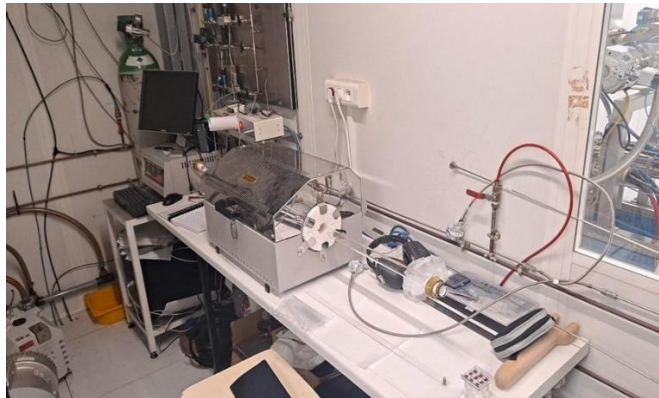
Figure 4.1. Four CVD à pression atmosphérique utilisé durant les croissances au sein du laboratoire de physique de l'École Normale Supérieure. L'arrivée des gaz se fait par l'une des extrémités du tube en quartz. L'échantillon est placé directement dans la zone du tube qui va chauffer.
