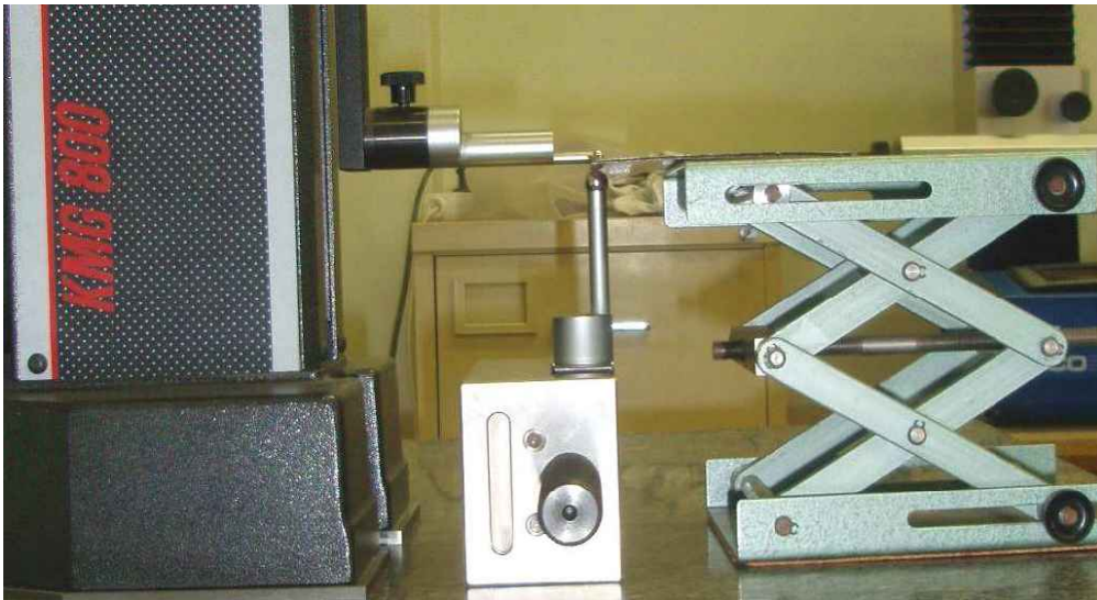
Figure 3.16 : Montage tribologique utilisé pour mesurer les épaisseurs des éprouvettes au micromètre près.
