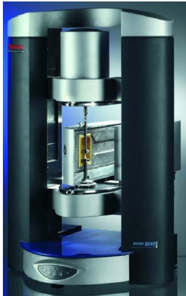
Figure 2.18 : rhéomètre utilisé pour effectuer les relevés de la viscosité de la résine R1 en fonction de la température.
