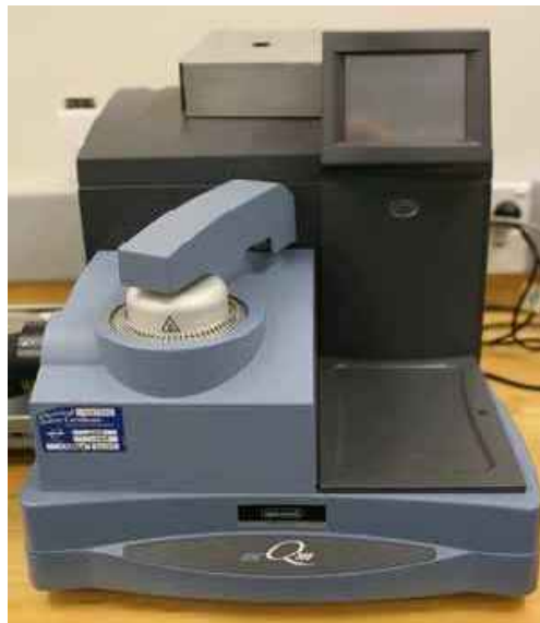
Figure 2.8 : Equipement utilisé pour faire les analyses DSC.
