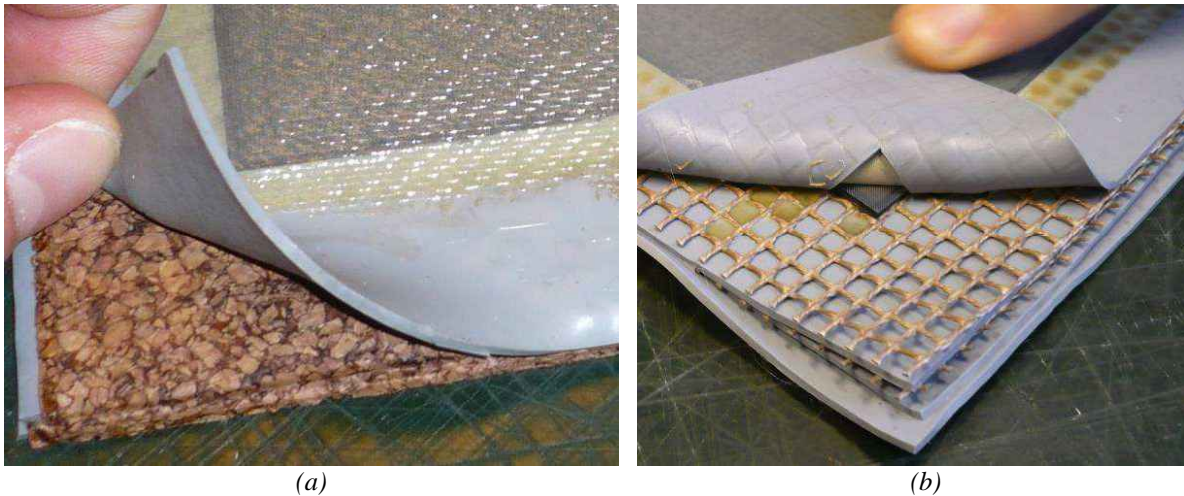
Figure 3.23: Solutions technologiques proposées pour rendre le cadre de coffrage de la pièce perméable à la résine et au gaz : (a) alternance de liège et de mosite ; (b) alternance de grillage PTFE et de mosite.
