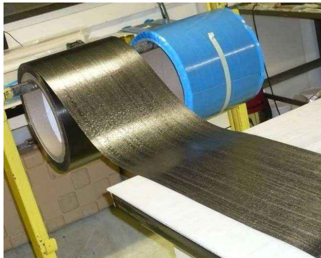
Figure 2.1 : Rouleaux de nappe unidirectionnelle de fibres de carbone préimprégnées de résine époxyde R1
