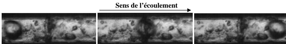
**Figure IV.6 :** Passage d'une goutte de TPGDA dans une connexion entre deux capillaires de 180 microns de diamètre interne
