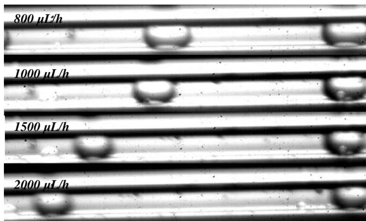
**Figure III.18 :** Visualisation des gouttes obtenues dans un réacteur à capillaire de section carrée (100  $\mu\text{m}$ ) pour des débits d'eau croissant et à débit d'huile fixé (200  $\mu\text{L}\cdot\text{h}^{-1}$ )
