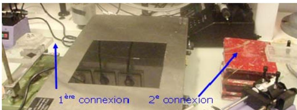
**Figure II.32 :** *Connexion avec un support intermédiaire pour des capillaires de section carrée*
