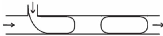
**Figure I.9 :** Génération de gouttes dans une jonction en T (Garstecki *et al*, 2006)
