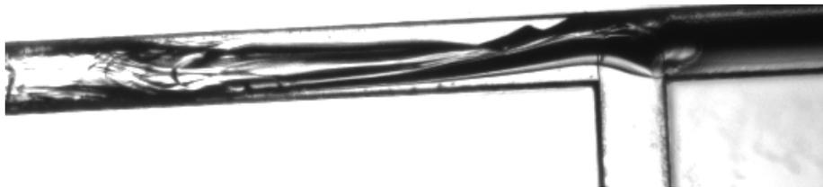
**Figure V.30 :** *Perturbation de l'écoulement stratifié du à la présence d'eau dans le canal principal lors de l'injection d'octanol dans le 1,4 butanediol*
