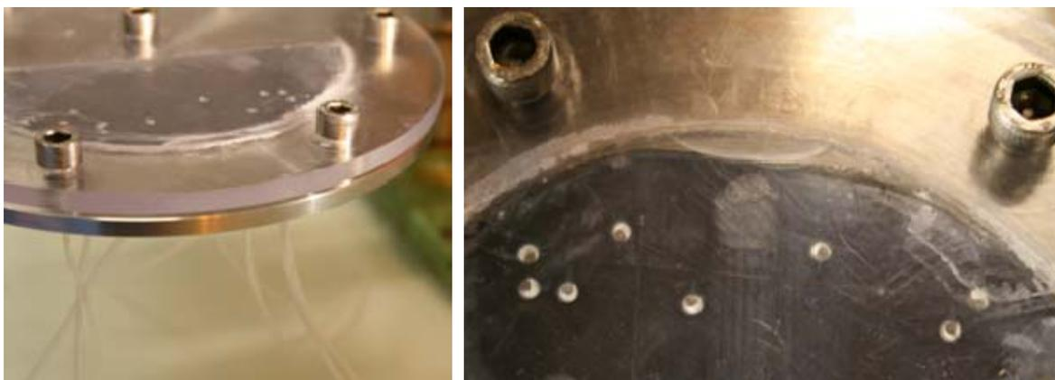
**Figure II.10 :** Photo du support avec septa en vue latérale (gauche) et vue de dessus (droite)
