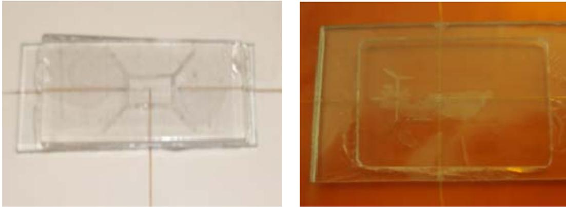
**Figure II.20 :** Exemples de microsytèmes en T et Croix obtenus à partir du collage par bicomposante
