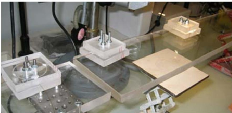
**Figure II.30 :** Connexion avec un support intermédiaire pour des capillaires de section carrée
