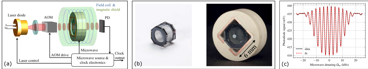
FIGURE 1.15 – (a) Architecture de l'horloge Rb POP à microcellule. (b) Photographie de la cellule disposée en cavité micro-onde. (c) Franges de Ramsey détectées en microcellule. Figures extraites de [75].
