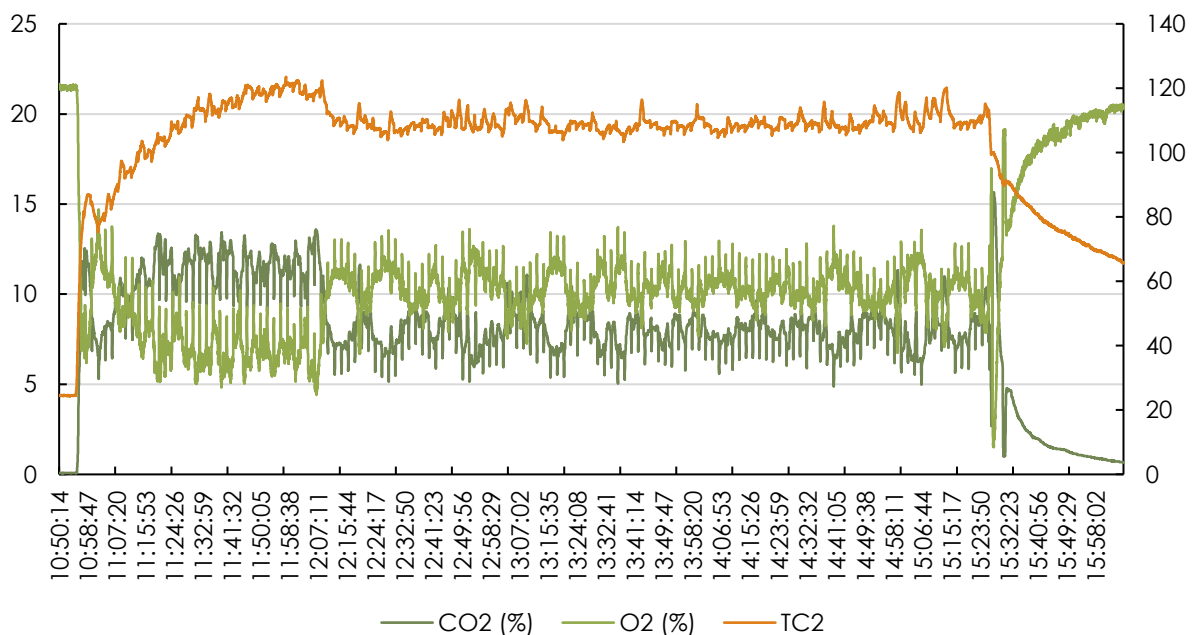
Figure A 1. Représentation d'un essai complet en chaudière REKA (SSD 8 % d'humidité) par les teneurs en CO 2 , O 2 ainsi que la température des fumées après l'échangeur de chaleur.
