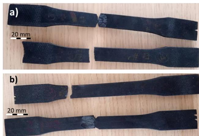
Figure 75. Eprouvettes de traction dépressurisées : a) EPDM1 b) NBR1.
