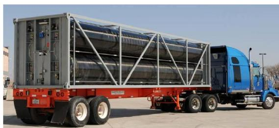
Figure 120. Camion d'hydrogène prototype équipé de réservoirs type IV et développé la société américaine Hexagon composites [98].
