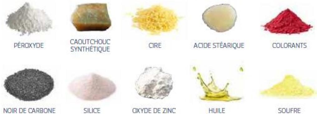
Figure 13. Exemple d'ingrédients entrant dans la composition des élastomères [27].
