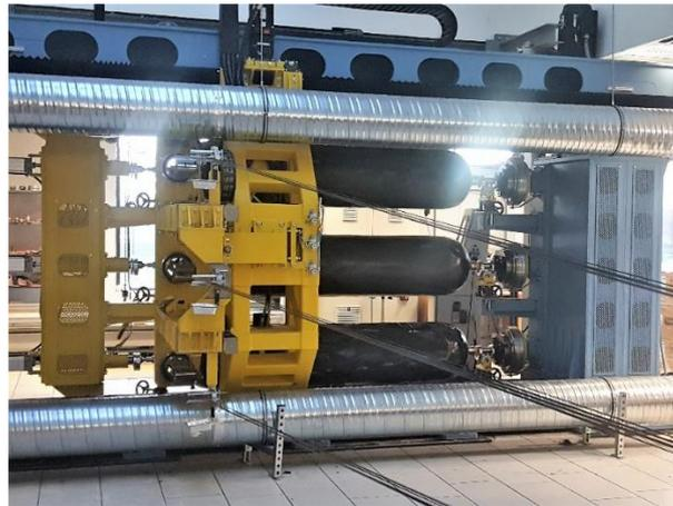
Figure 9. Illustration de l'enroulement filamentaire (photo Mahytec)[14].
