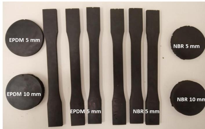
Figure 86. Lot d'éprouvettes standards à insérer lors de chaque essai.
