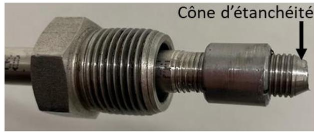
Figure 66. Exemple de raccord.
