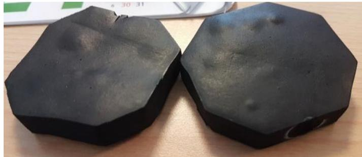
Figure 73. NBR1 (à gauche) et EPDM1 (à droite) après dépressurisation.
