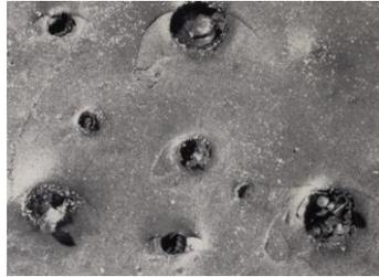
Figure 20. Cavitation dans un élastomère après un essai de traction [64].
