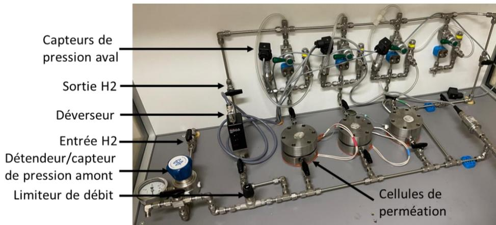
Figure 55. Dispositif de perméation du laboratoire.
