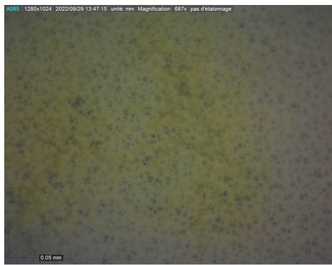
(a) Jaunissement de la membrane après exposition au plasma
