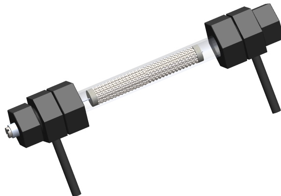
Figure 3.3 – Schéma d'un réacteur Packed-Bed rempli de billes d'alumine.
