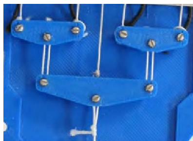
FIGURE 1.7 – Trois palonniers d'équilibrage arrangés en série pour équilibrer la tension des quatre tendons de sortie ( source : [30])
